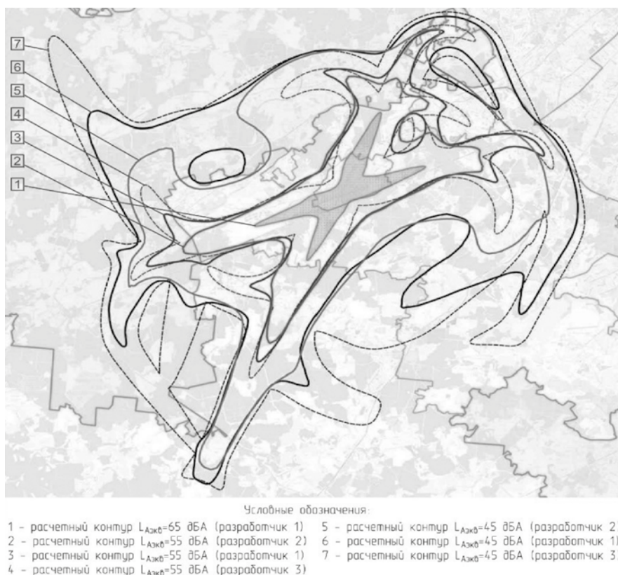
Рис. 2. Сравнение вариантов расчетных контуров авиационного шума аэропорта Москва (Внуково) при использовании модели AEDT различными разработчиками [7]
